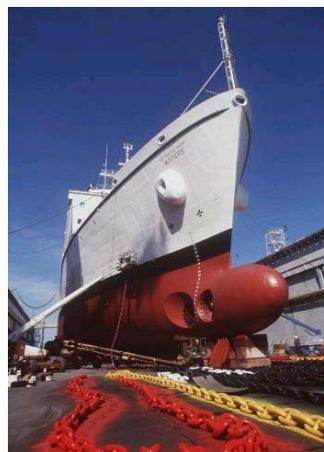
Les peintures antifouling ou antisalissure sont des revêtements de finition destinés à empêcher la fixation d'animaux ou de végétaux sur les carènes des navires. Ces peintures sont utilisées pour des raisons de sécurité, de maintien de la manoeuvrabilité du navire, de lutte
