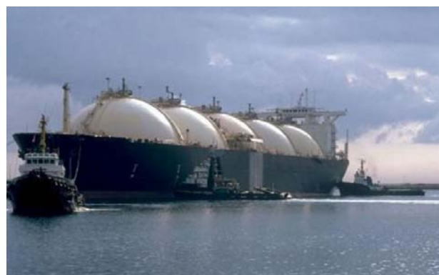
Méthanier en manœuvre portuaire
